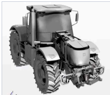
그림 9: 거의 14,000개의 부품을 정확하게 시뮬레이션하는 STAR-CCM+에 내장된 모델
